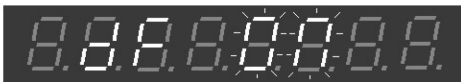
Rys. 12. Załączenie cyfrowej eliminacji przypadkowo zliczanych impulsów.
