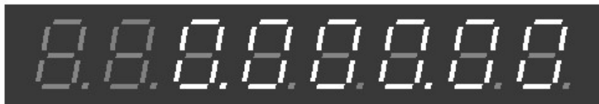
Rys 3. Stan wyświetlacza po zmianie czasu bramkowania z 1s do 0,1s przy pracy w dolnym zakresie pomiarowym (Ch L)
