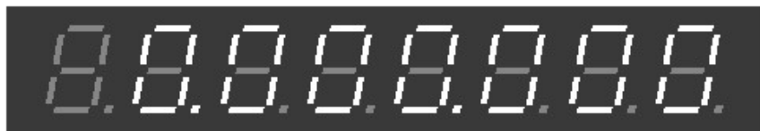
Rys. 2. Wyświetlanie stanu zerowego licznika z rozdzielczością 1 Hz w zakresie (Ch L)
