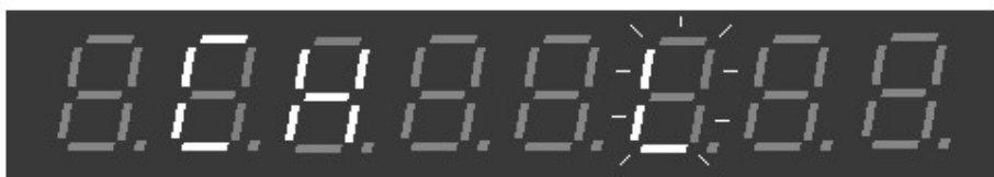
Rys. 8. Wybór dolnego pasma pomiarowego LF (Ch L)
