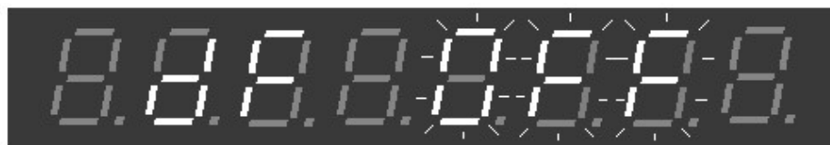
Rys. 13. Wyłączenie cyfrowej eliminacji przypadkowo zliczanych impulsów.
