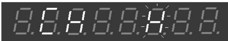
Rys. 9. Wybór górnego pasma pomiarowego HF (Ch H)
