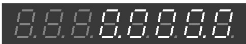
Rys 4. Stan wyświetlacza po skróceniu czasu bramkowania w zakres H
