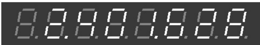
Rys. 11. Wyświetlanie wartości licznika z pomiaru szumu preskalera przy wyłączonej funkcji eliminacji.
